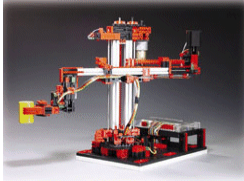
Figura - 20: Exemplo de montagem com material Fichertechnik
