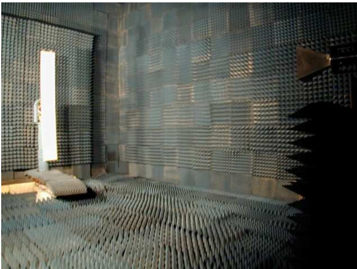
Figura 17 Isolamento de uma câmara anecóica.
