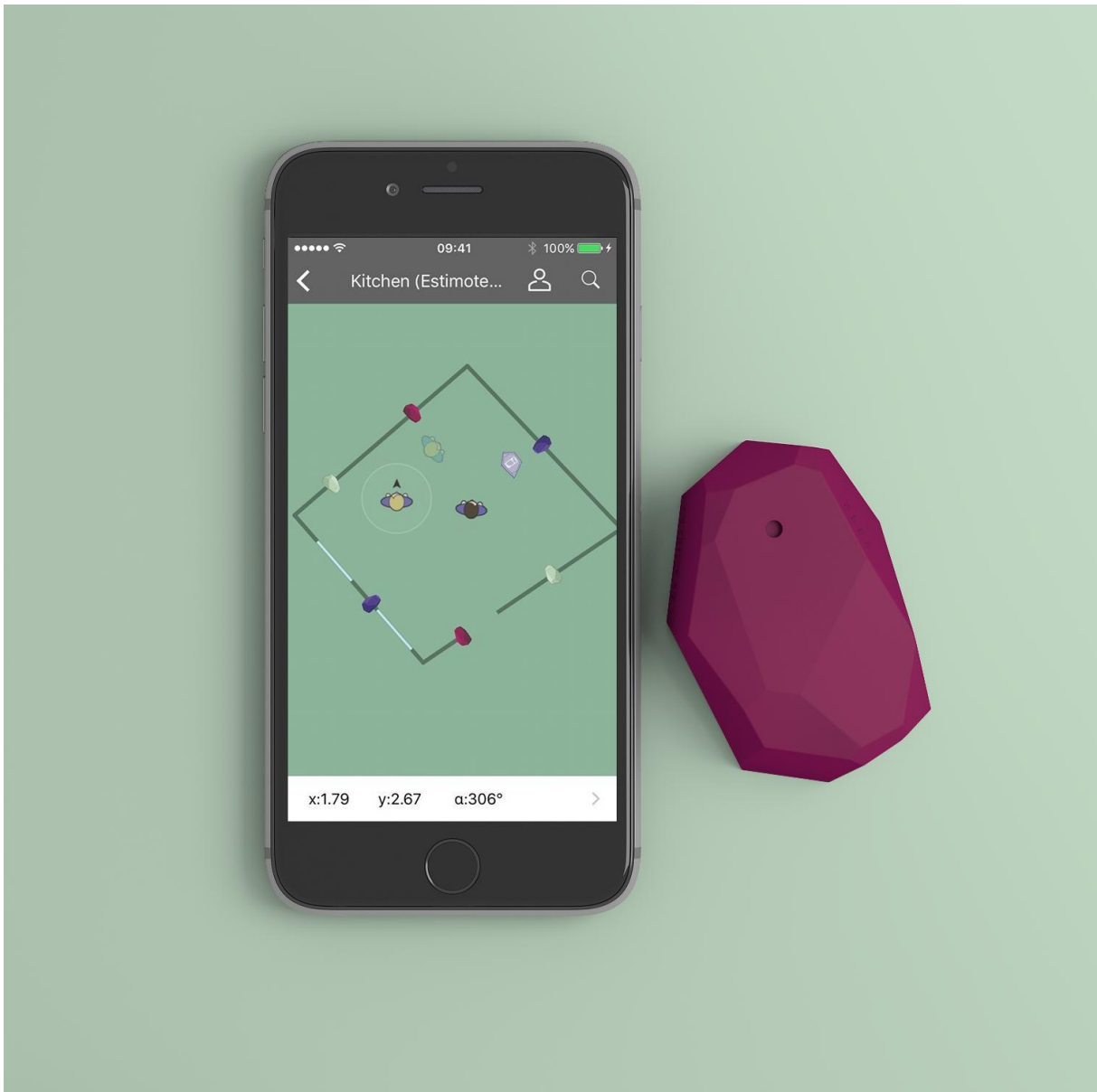
Figura 7: Beacons. Dispositivo de baixo consumo de energia que pode ser fixado em paredes ou objetos. Com uso de tecnologias de proximidade eles podem detectar a presença de pessoas e objetos
