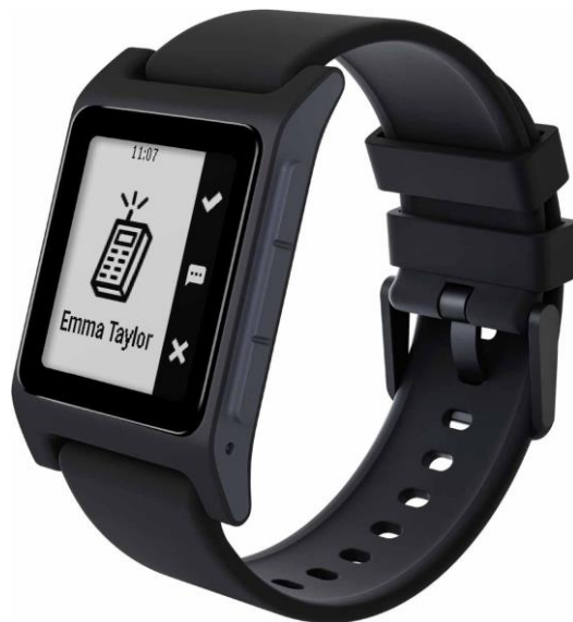
Figura 14: Pebble Smartwatch. Conecta-se ao smartphone para exibir mensagens ou alertas de aplicativos.
