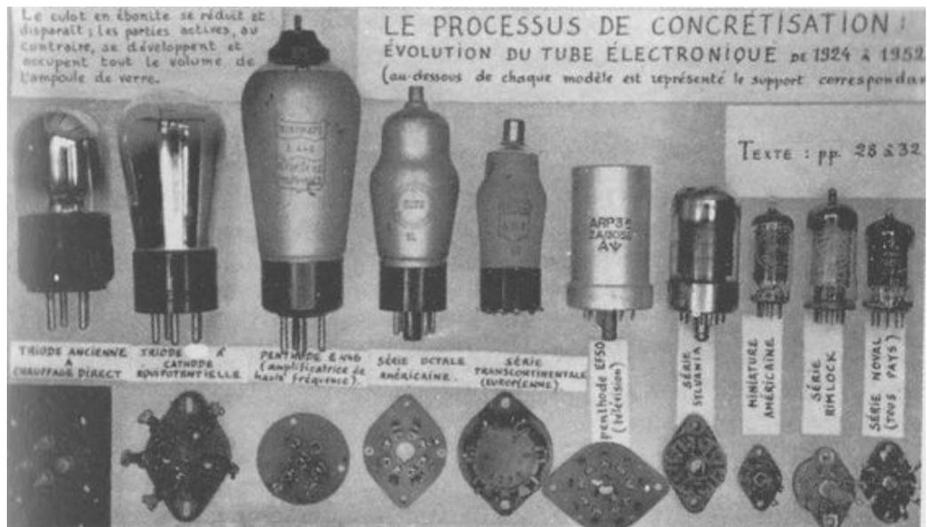
Fig. 3. Processo de concretização segundo Simondon (MEOT, 2012, *planche 4*)
