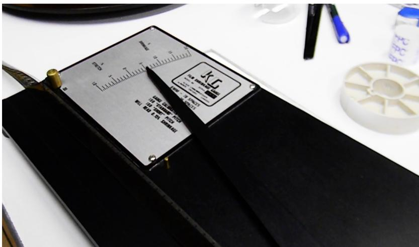
**Figura 62.** Medidor de encolhimento de filme medindo um filme em 16mm. Fonte: imagem concebida nos dias de pesquisa no laboratório da Cinemateca Brasileira.
