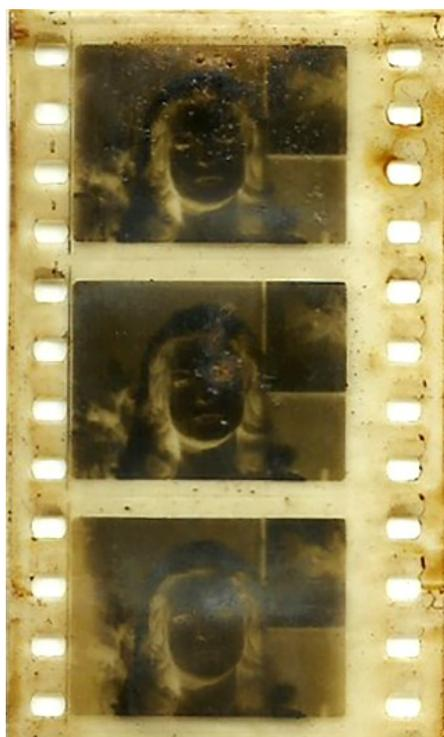
**Figura 60.** O negativo de uma película com traços de deterioração típica de um país tropical: nota-se a presença de fungos, queimaduras nas perfurações, e nos dois primeiros fotogramas pequenas bolhas causadas devido absorção de umidade. Fonte: material de acervo pessoal.
