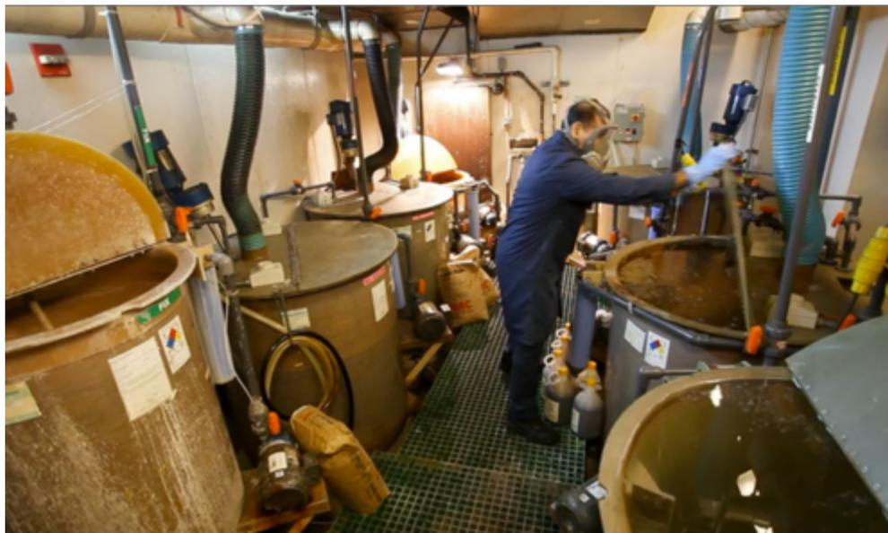
**Figura 21.** Tonéis químicos onde películas são submergidas Fonte: Documentário *Side by side*, 2012.
