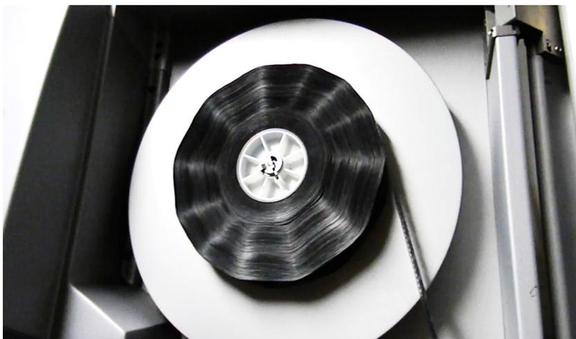
**Figura 65.** Filme deteriorado inserido na Arriscan. É nítida a deformação por conta deterioração. Fonte: imagem concebida nos dias de pesquisa no laboratório da Cinemateca Brasileira.
