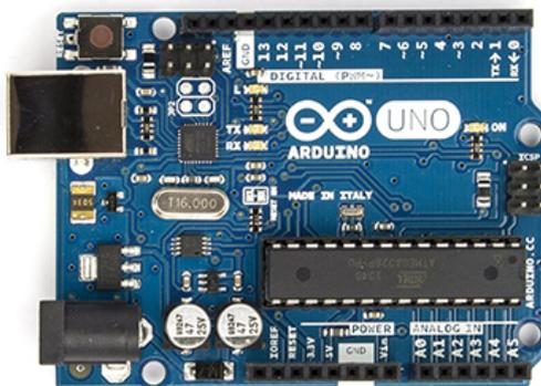
Figura 22 – Placa Arduino Uno. Fonte: Arduino (2014).
