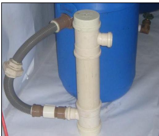
Figura 16 - 3.1.1.9 – Filtro de carvão ativado. Fonte: FITO (2009).
