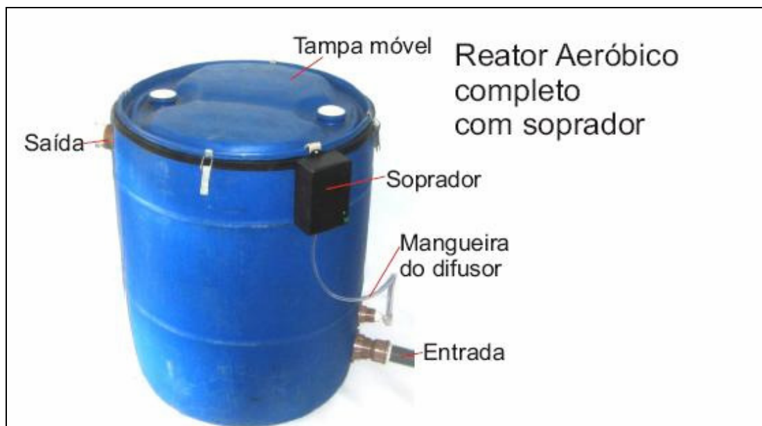
Figura 24 - 3.1.1.17 – Reator aeróbico completo com soprador. Fonte: FITO (2009).
