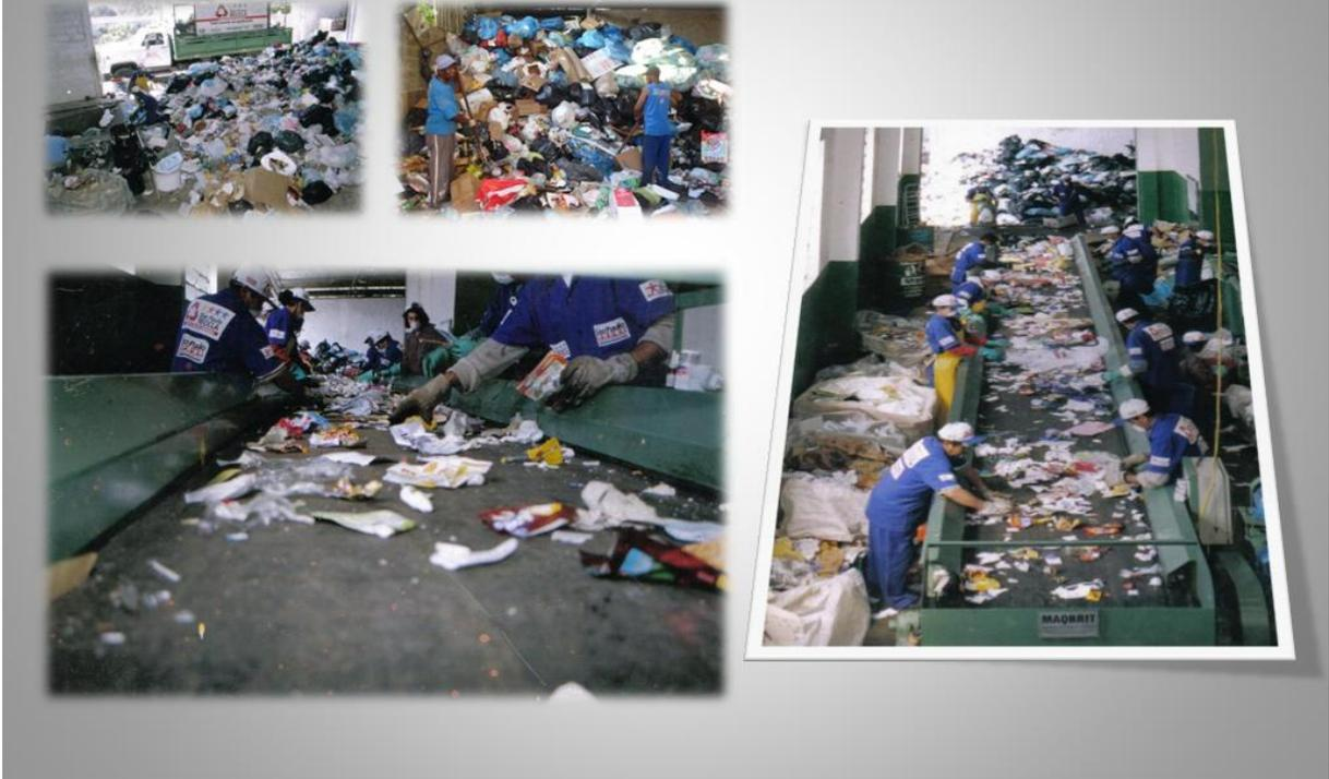
Legenda: foto esteira de triagem de material coletado. Processo de carregamento da esteira e trabalho de retirada e triagem.
