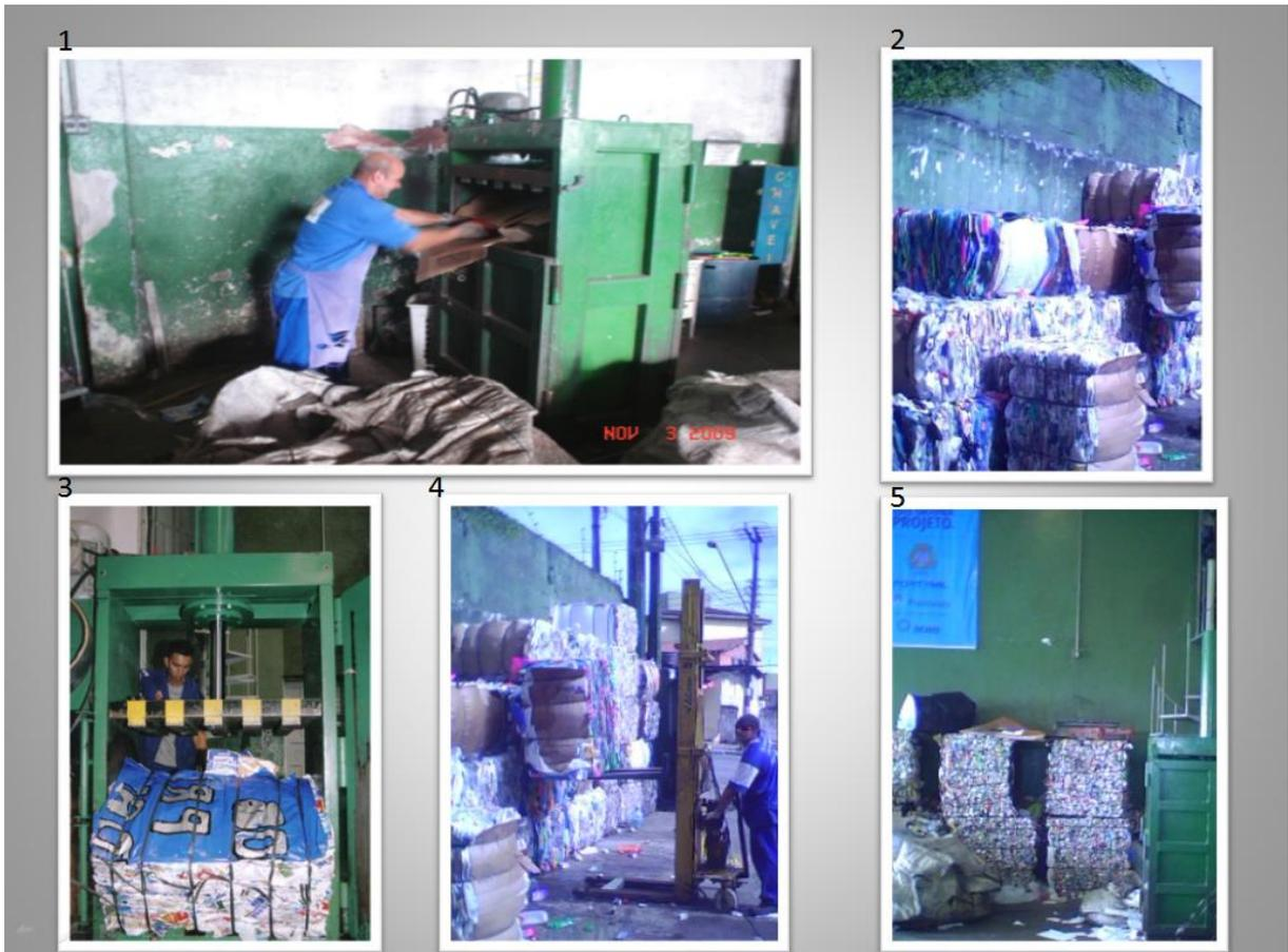
Legenda: 1 – Processo de prensa de papelão/ 2 – Material prensado/ 3- Foto do material saindo da prensa, recém-prensado/ 4 – Processo de empilhamento de material prensado para carregar o caminhão/ 5 - Estoque de material prensado.
