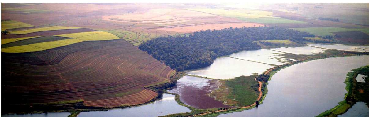
Foto 4. Ensecadeiras já exploradas. A argila foi extraída e o dique rompido. Vê-se claramente o leito original do rio. S/IA. Fonte: Arquivo AES Tietê. Ano: [2000]
