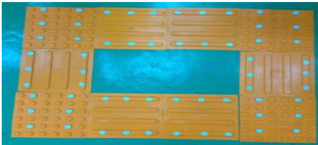
Figura 8: Instalação das etiquetas no Piso tátil.
