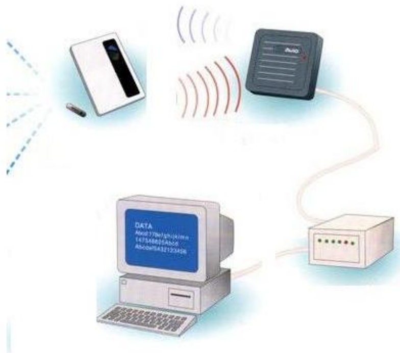
Figura 11 – Sequência de aquisição de dados utilizando tecnologia RFID.
