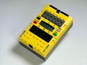
O RCX pode ser programado para interagir com o meio através de uma variedade de sensores e peças: como lâmpadas e motores.
