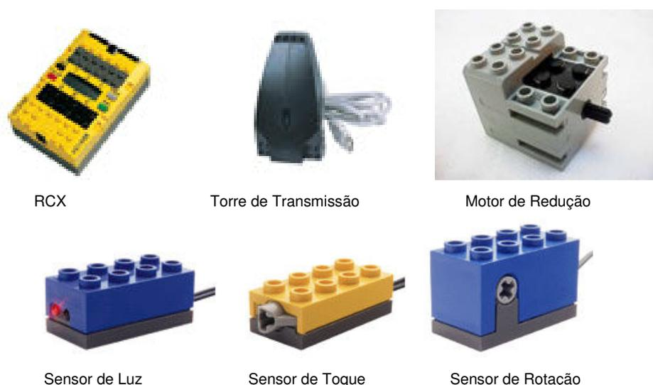
Figura 2.2 – Partes do Kit ROBOLAB
