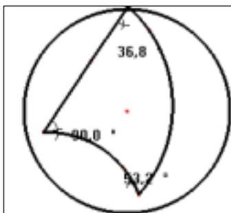
FIGURA 68 – REPRESENTAÇÃO DE UM TRIÂNGULO ESFÉRICO COM UM ÂNGULO RETO
