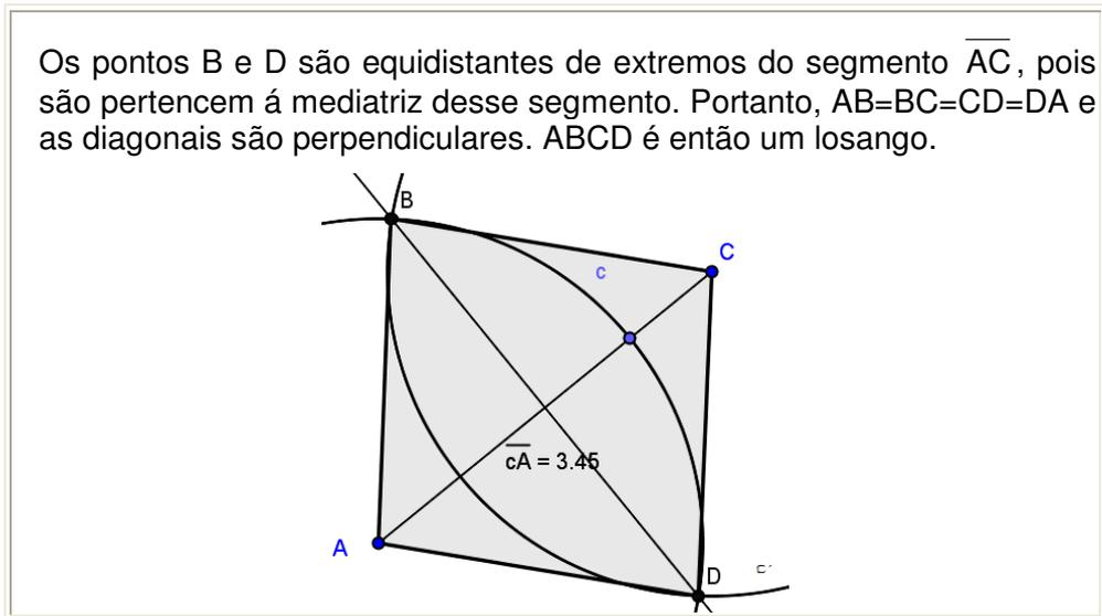
**Atividade 5:** Construir um losango a partir de um lado e a direção de uma diagonal.
