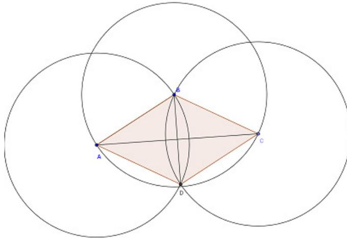
**Atividade 4:** Construir um losango a partir de uma diagonal  $\overline{AC}$ .
