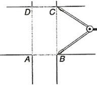
**Figura 13.** Construção de paralelogramos
