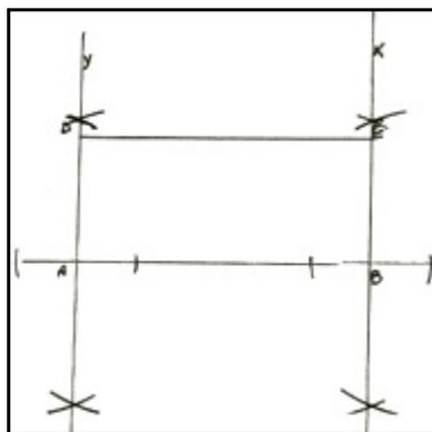
**Figura 18.** Construções do Retângulo com régua e compasso
