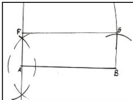
**Figura 20.** construção do retângulo com régua e compasso
